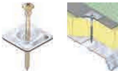
Fijación mecánica de aislante y membrana bituminosa sobre chapa de acero
