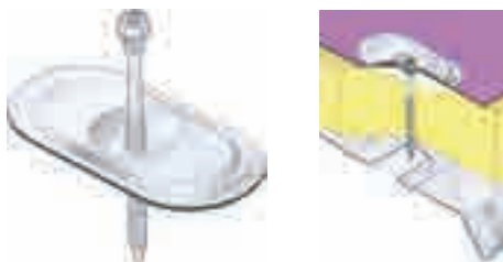
Fijación mecánica de aislante y membrana sintética sobre chapa de acero
